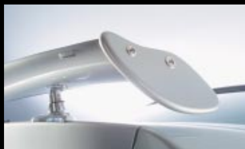
Der AC Schnitzer Heckflügel reduziert die Auftriebswerte laut Windkanaltest der Zeitschrift „sport auto“ um 21,3 kg.
