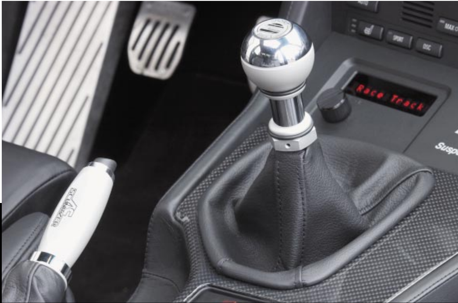
AC Schnitzer Carbon-Innenausstattung im ACS5 Sport sowie AC Schnitzer Schaltwegeverkürzung Short Shift inkl. Aluminium Schaltknopf, AC Schnitzer Aluminium Pedalset und AC Schnitzer Handbremshebel (oben)
