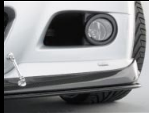
Aluminiumstrebe zur Stabilisierung des Frontspoilers am AC Schnitzer ACS3 Sport
