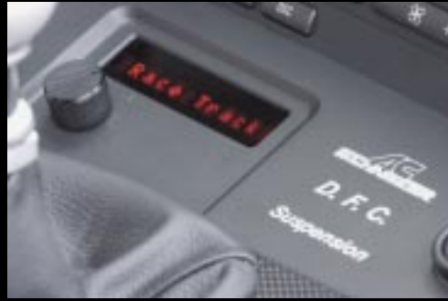
Bedienungselement des DFC-Rennsportfahrwerkes mit Display in der Mittelkonsole des ACS5 Sport
